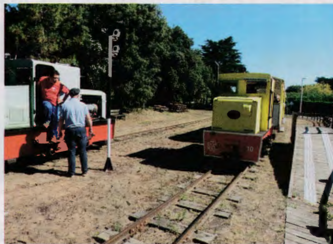
Pour la traction, des locotracteurs Billard ont succédé à des Deutz.
