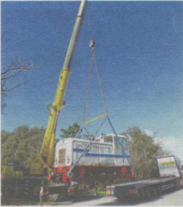
La locomotive est suspendue à un palonnier sur lequel sont rattachées les 4 sangles. ©A.V.
